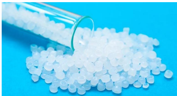
Figure II.3 : Matériau à changement de phase. [30]
