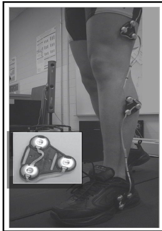
Figure 16 : Système de capture de mouvement actif dans un laboratoire de biomécanique suit la position relative des marqueurs en illuminant des LED.
