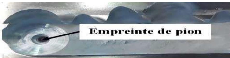
Figure I.8. Trou à la fin de soudure [71]
