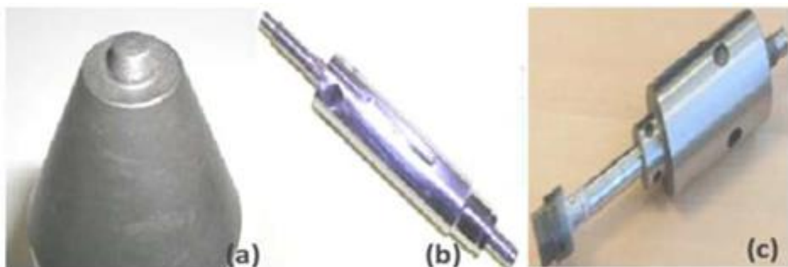
Figure I.15. Les technologies d'outils existants (a) Outil conventionnel, (b) Outil à pion rétractable et (c) Outil à deux épaulements et un pion ajustable verticalement.
