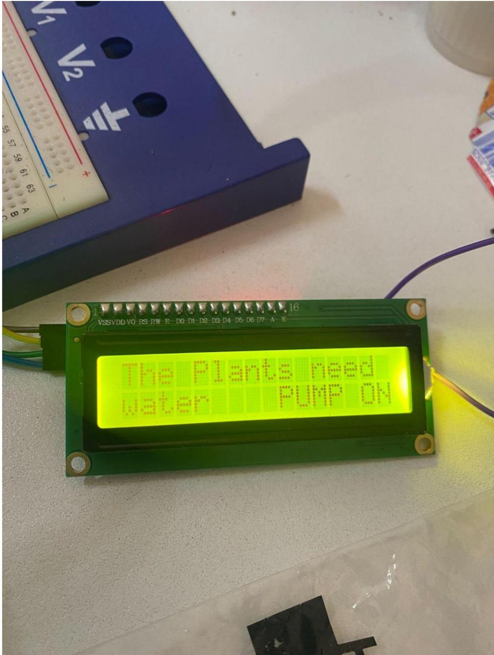
**Figure III-11 : Sol sec « PUMP ON »**
