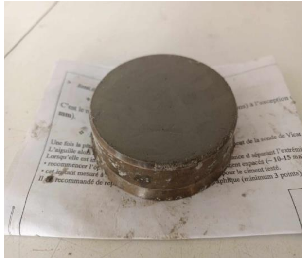
Figure III 13 : Photo d'un échantillon avant consolidation
