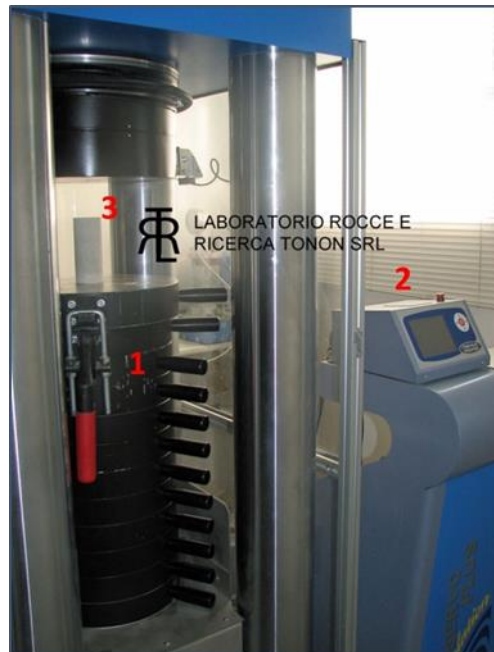
Figure I.6: Appareillage pour effectuer des essais mono-axes, présent au Laboratoire des Roches et de Recherche de Tonon
