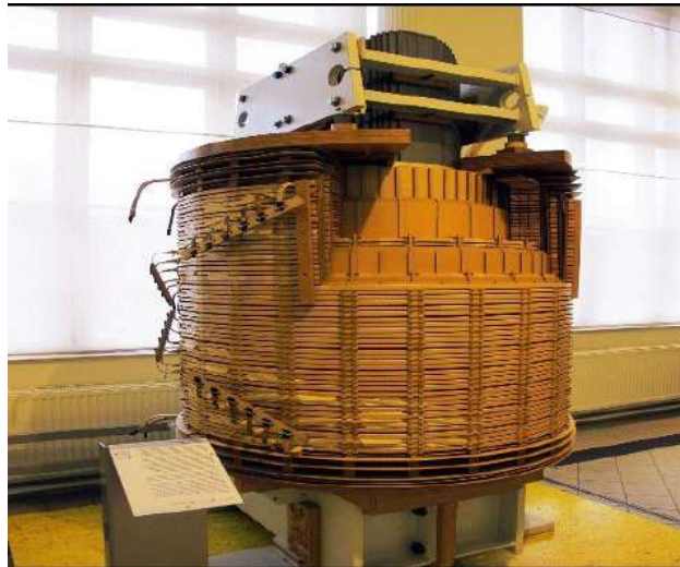
Figure 1.7 : Les enroulements dans le transformateur.
