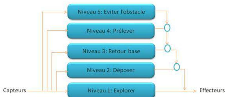
Figure II.3: Architecture Réactive de Subsomption (Robots explorateurs de Mars)
