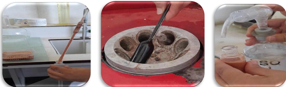
Figure 14: Mesure du taux de la matière grasse.
