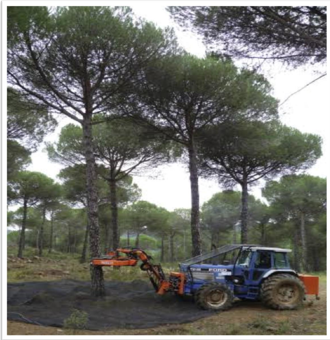
Figure 12. Rendement mécanisé des cons de Pinus Pinea avec des secoueurs d'arbres ( Castro-Garcia et al., 2012 ).
