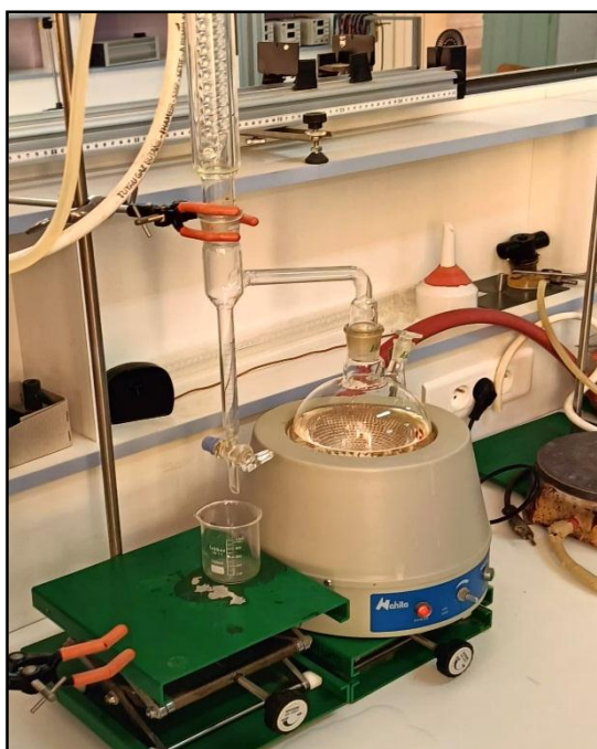
Figure_N°I7 : Dispositif utilisé pour l'extraction des HEs.
