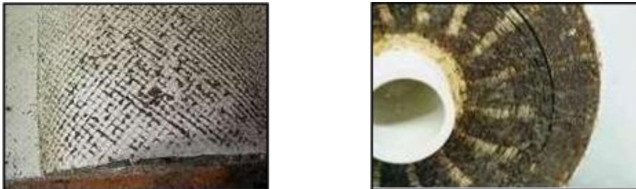
Figure II.5 : Colmatage des membranes
