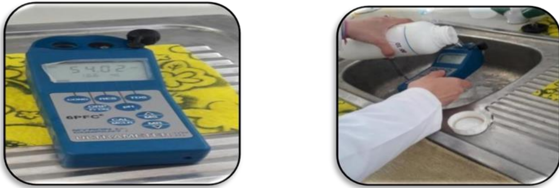
Figure III.1 : l'appareil de multi paramètre de mesure la température et le ph et la conductivité
