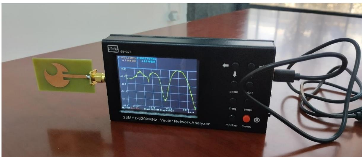
Figure II. 30–Mesure de l'antenne patch circulaire simple avec l'analyseur réseau.
