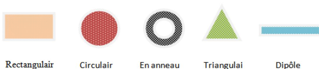
Figure I. 2– Différentes formes de l'élément rayonnant (patch) des antennes imprimées.
