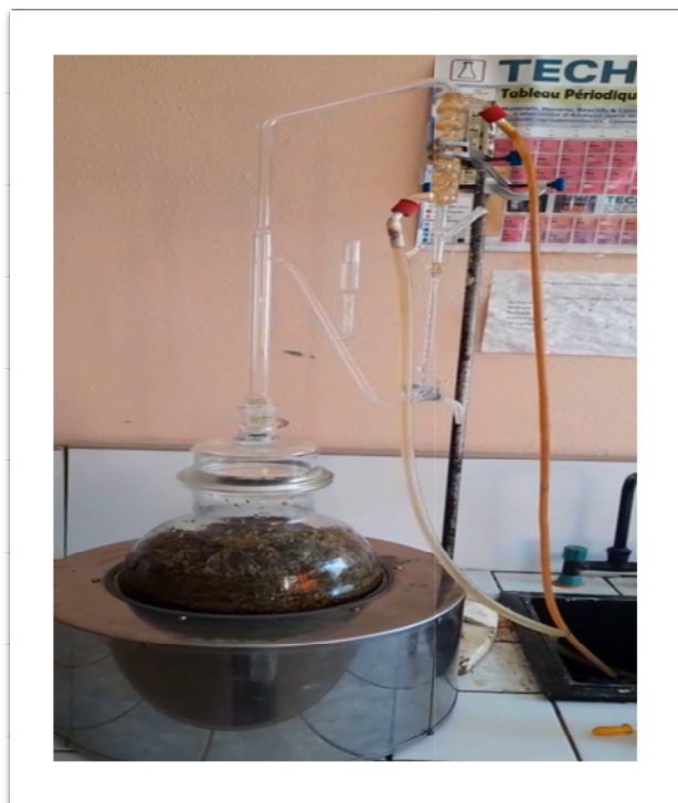
Figure 9: Appareillage utilisé pour l'extraction par Hydrodistillation
