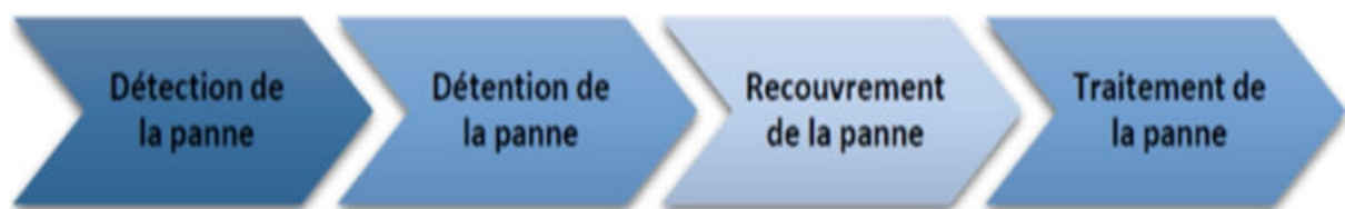
Figure II.5: Procédure générale de tolérance aux pannes.
