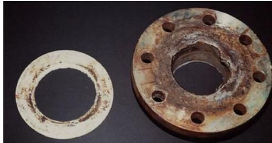
**Figure II.7.** Corrosion caverneuse
