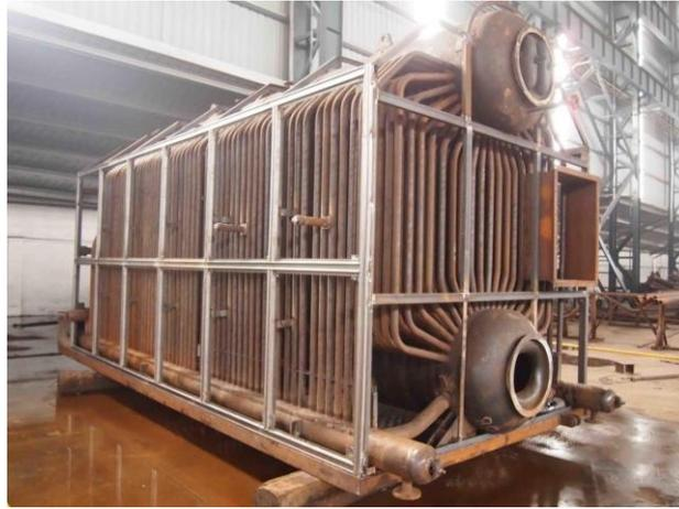
**Figure I.2.** Chaudières à tubes d'eau
