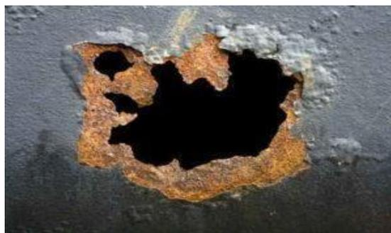
**Figure II.5.** Corrosion par piqure
