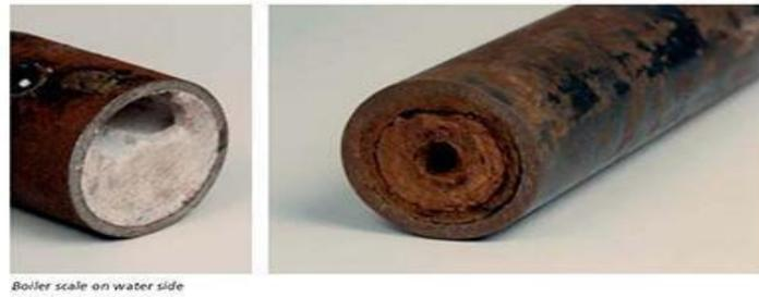
**Figure II.1 :** Tube d'eau de chaudière entartré
