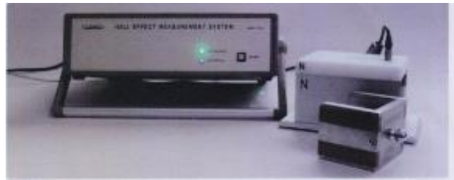
Fig.III.6 : illustration d'appareil effet Hall
