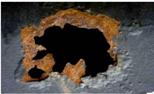
Figure I.8. Exemple de corrosion par piqûre [15]
