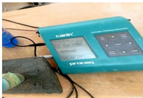
Figure III.7 . La mesure de potentiel de corrosion a été réalisée à l'aide de l'appareil CANIN+
