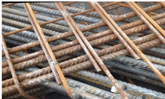
Figure I.2. Les armatures pour béton armé [3]
