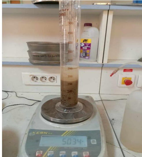
Figure 3. 7 L'essai de la masse volumique absolue (photo prise par les auteurs)
