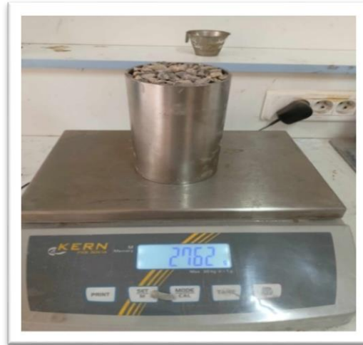
Figure 3. 6 Essai de la masse volumique apparente (photo prise par les auteurs)
