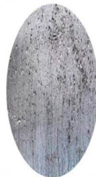
Corrosion par érosion
