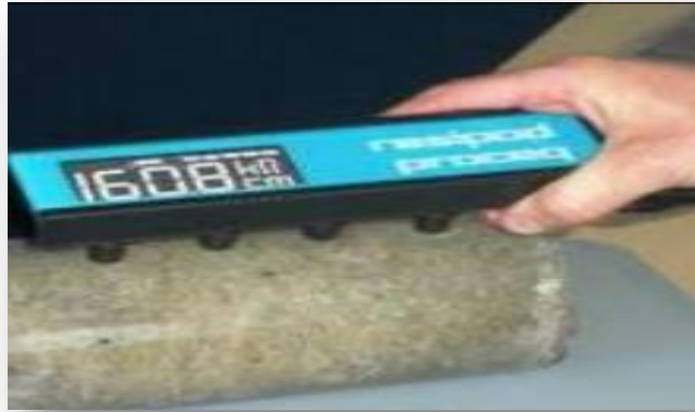
Figure 1. 21 Exemple de matériel commercialisé pour la cartographie de la résistivité de type Wenner (IFSTTAR) [23]
