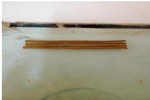
Figure III. 6 : Les étapes de la limite de plasticité.
