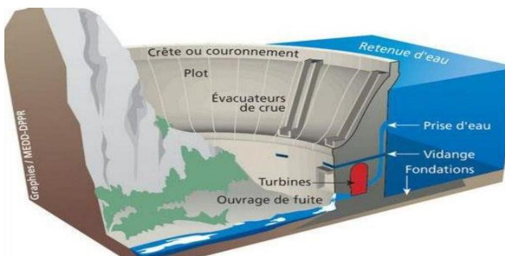
Figure I.1 : Les différentes parties d'un barrage [2]
