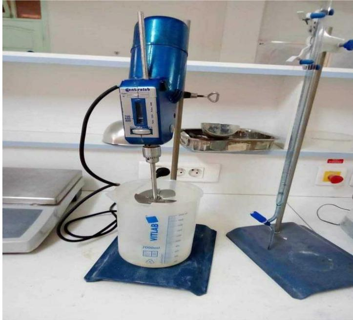
**Figure III.8:** Appareillage de l'essai de bleu
