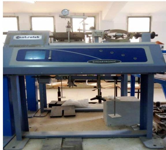
**Figure III. 17 :** Machine de cisaillement utilisé dans cette étude
