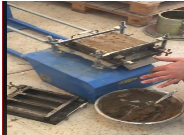
Figure III.16. Le remplissage de moule
