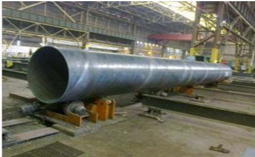
Figure 6 : Les tubes soudés sous la forme en spirale [13]
