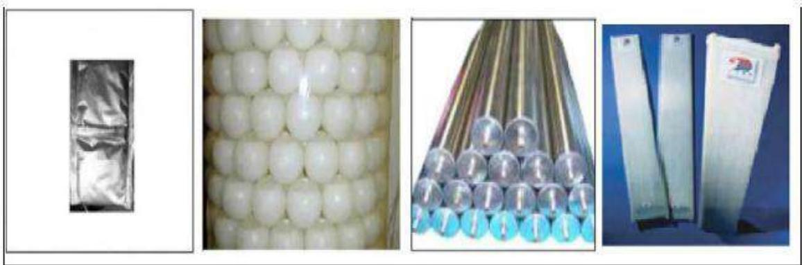
Figure II.3 : Photographie des MCP macro-encapsulés : pochettes, sphères, tubes, plaquettes [29]
