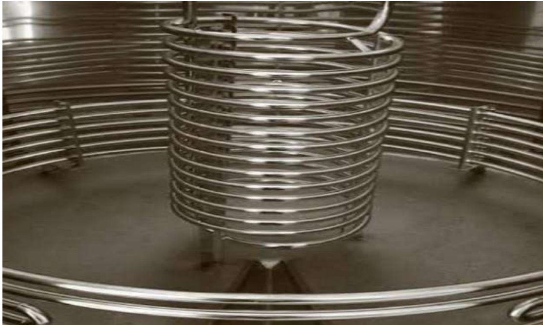
Figure II.19 : échangeur sous forme d'un serpentin
