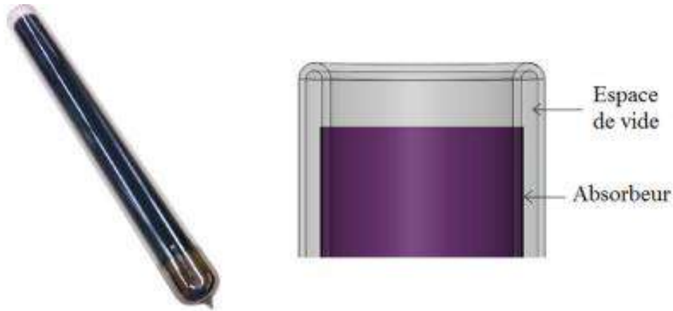
Figure II.8 : Tube sous vide en forme d'éprouvette (à gauche) et vue en coupe de l'extrémité d'un tube (à droite)
