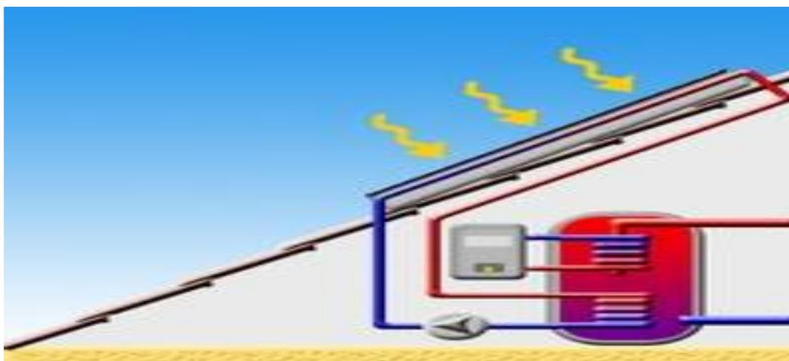
**Figure1.10** : Schéma chauffe-eau à circulation forcée [3]
