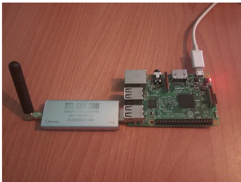
Figure 4. 6: Système proposé à base de la clé RTL-SDR et la carte Raspberry Pi 3.
