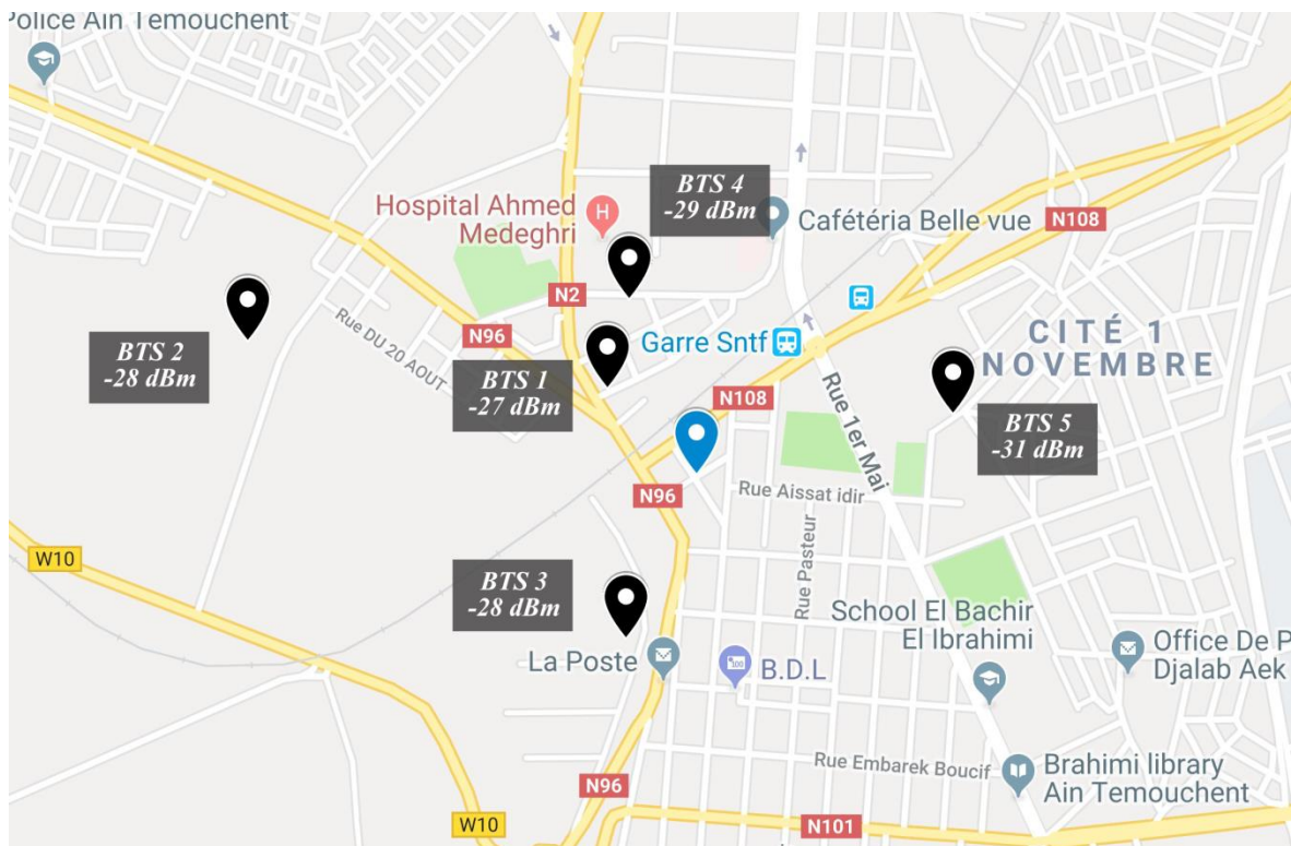
Figure 4. 10: Emplacements des BTSs détectées avec leurs puissances reçues.
