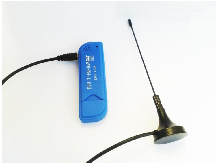
Figure 2. 5: La clé RTL-SDR avec une antenne omnidirectionnelle.
