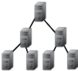
Figure 34 : Réseau en arbre[10]
