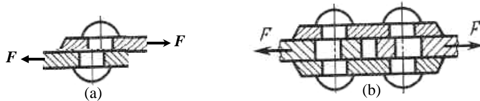
Figure 25 : Mode de cisaillement des rivures (a) section mono-cisailée (b) sections bi-cisailées
