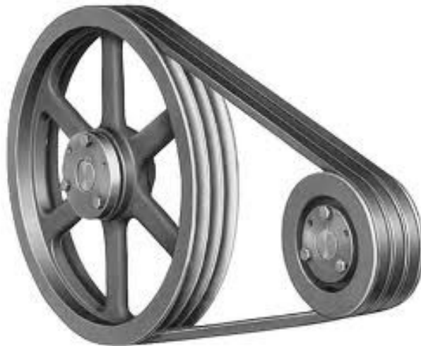
Figure 65 : Courroies parallèles et poulies multi gorges
