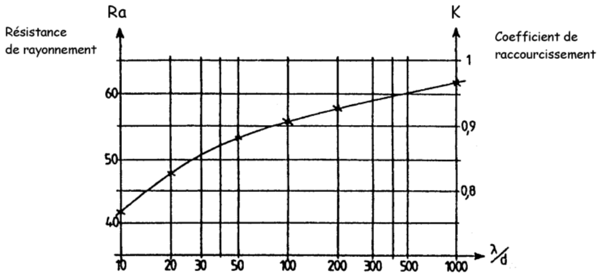
Figure 2.6 : Résistance de rayonnement et coefficient de raccourcissement en fonction de la longueur d'onde et du diamètre d [9]
