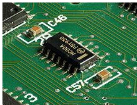
Figure I. 25 : puce électronique et deux condensateurs montés en surfaces sur un PCB. [5]
