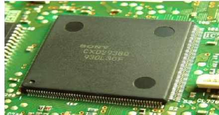
Figure I. 24 : microcomposants électronique à piquer. [5]
