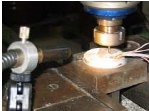
Figure II.4: photographie du dispositif de mesure des contraintes résiduelles sans les dépôts, méthode du trou incrémental. UTT-LASMIS. [13]
