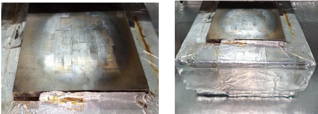
*Figure 3-5 : Système de chauffage du porte-substrat du bâti Holmarc.*
