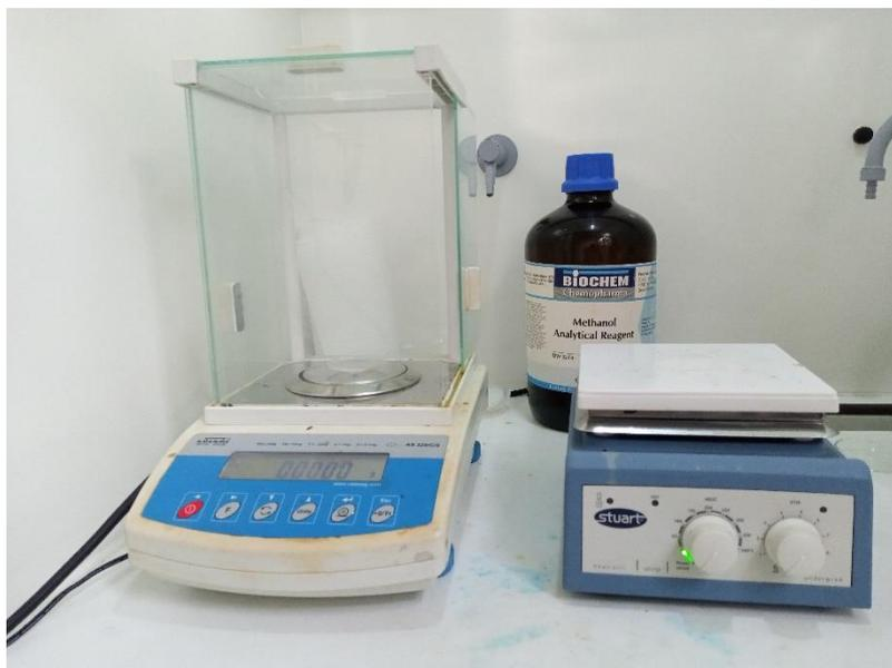
Figure 3-12: (a) Balance et (b) Agitateur thermique
