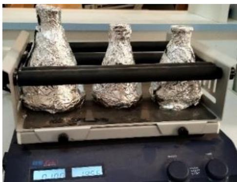
**Figure 10** : Macération sur agitateur magnétique (**Photo original, 2022**).
