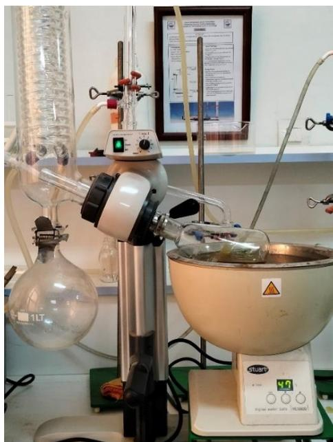
Figure 12 : Evaporateur rotatif sous vide (Photo original, 2022).
