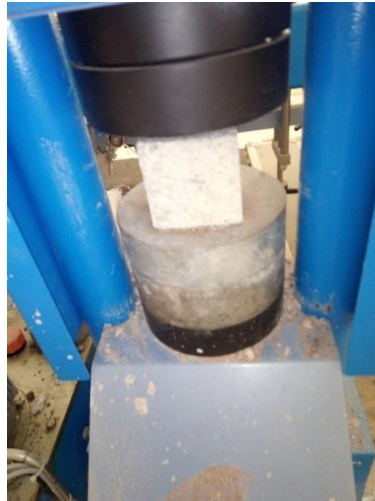
Figure 45: Écrasement des éprouvettes (7×7×7cm 3 ) à la machine 250KN
