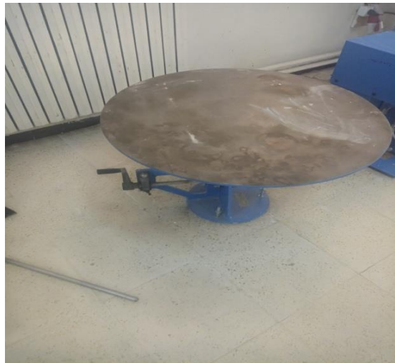
Figure 42 : la table de vibration du laboratoire de UAT
