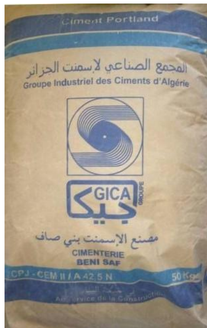
Figure 27 : le ciment utilisé dans notre béton CEM II/A 42,5
