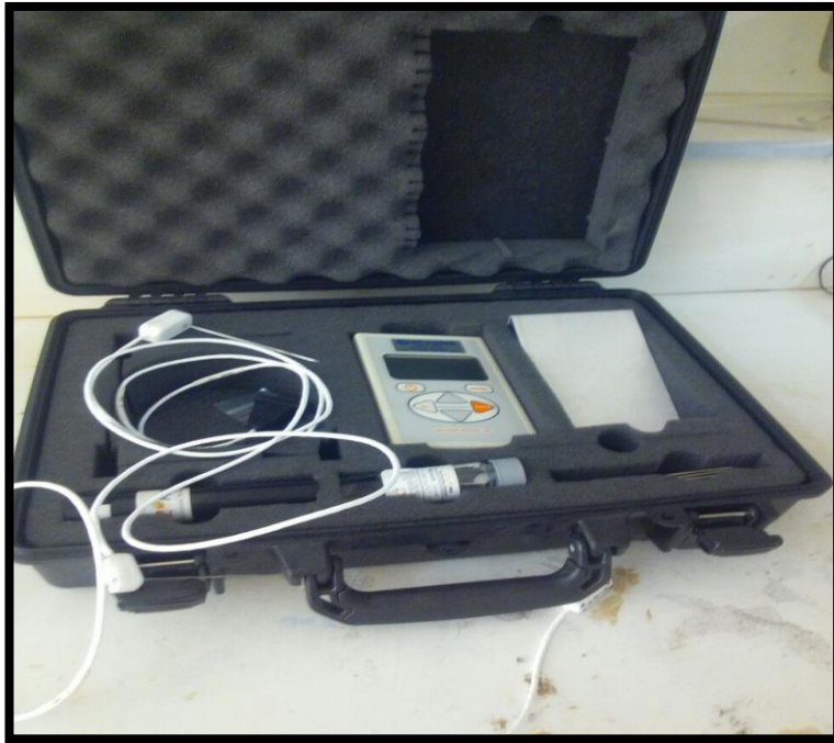
Fig. II-14 Appareil de mesure ce conductivité thermique
