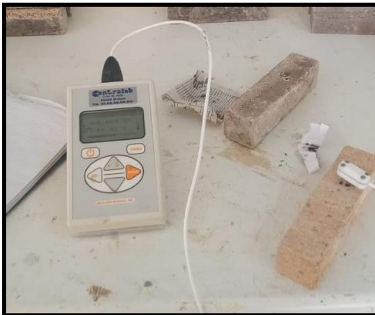
Fig. II-14 : Mesure de conductivité thermique
