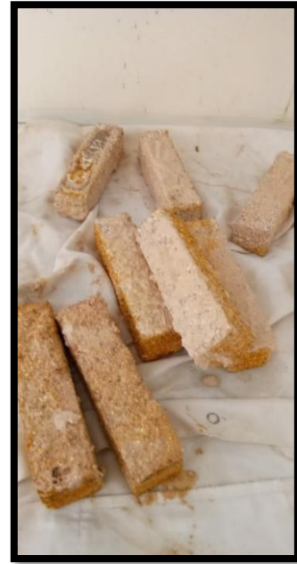
Fig. II-7: Epp après l'attaque chimique
