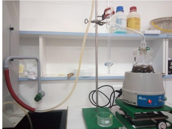
Figure 11: Le montage utilisé pour l'extraction d'huile essentielle ( hydrodistillation )
