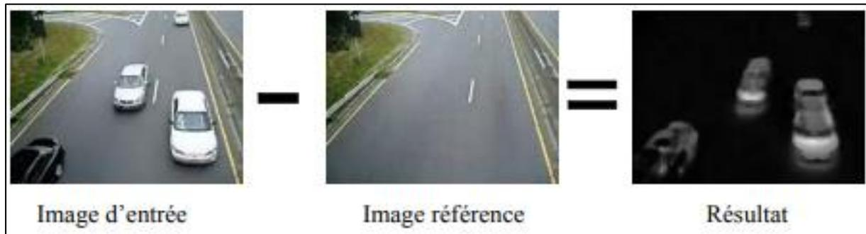
*Figure 7 : Illustration d'une opération de soustraction d'arrière-plan. [Fardjallah, 2014]*
