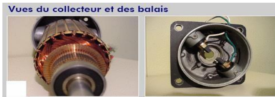
Figure (I.10) : Le collecteur et les balais. [9]
