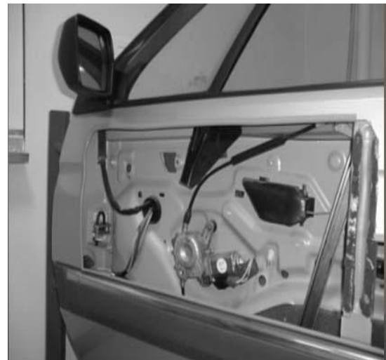
Figure (III.14) : Implantation du lève-vitre électrique dans une portière complet. [50]
