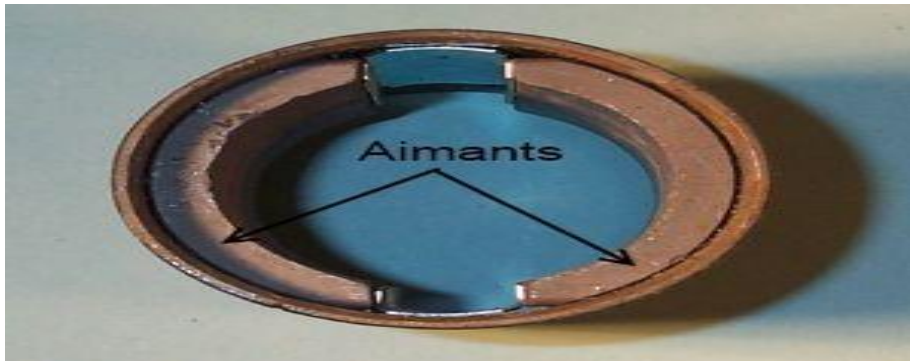
Figure (I.7) : Inducteur à aimant permanent. [7]
