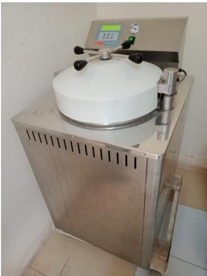
**Figure19 :** Autoclave (Photo originale)
