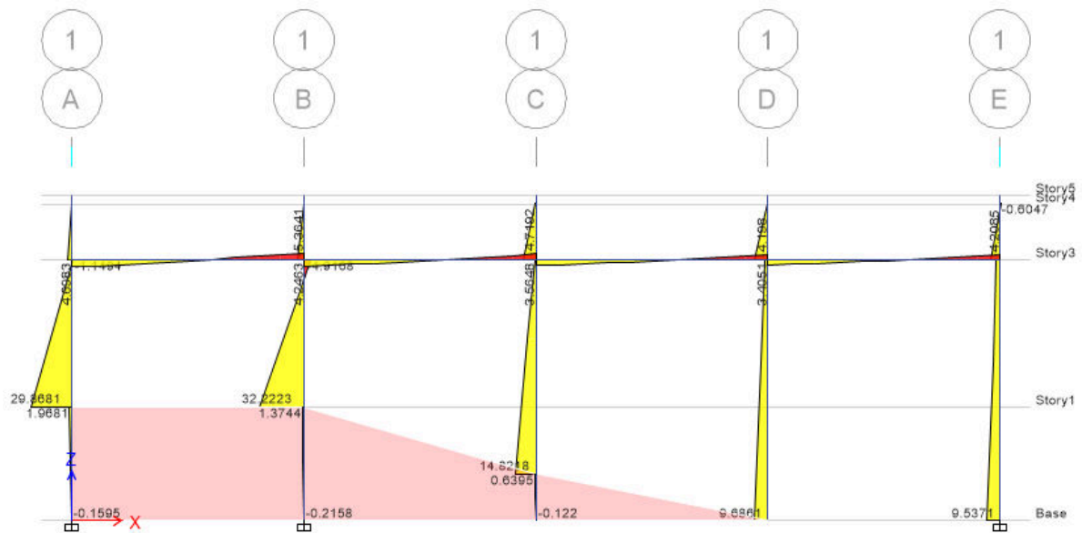
Figure V- 2 : diagramme des moments dans les poteaux HE280A.
