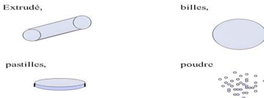
Figure I.3: Les différentes formes des catalyseurs [9].
