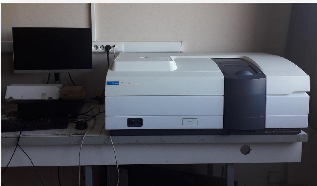
**Figure II.5 :** Un spectromètre UV/Visible.
