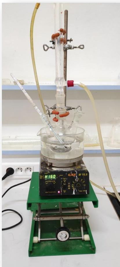
**Figure II.1** : Le montage à reflux d'acide succinique et l'éthanol.
