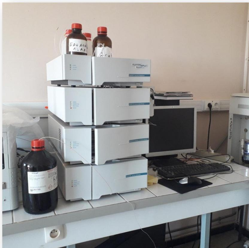
**Figure II.3 :** Chromatographie en phase liquide à haute performance (HPLC).
