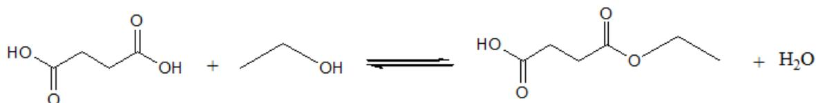
**Schéma II.1 :** Reaction d'estérification de l'acide succinique avec l'éthanol.
