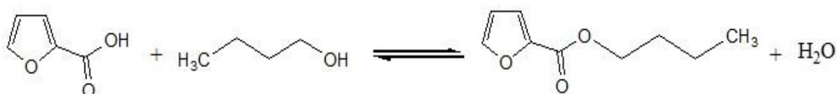
**Schéma I.10** : Modèle de la réaction d'estérification entre l'acide 2-furoïque et le n-butanol
