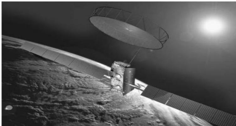
Figure I- 17 : Antenne à réflecteur (AstroMesh) d'INMARSAT-4 [1].
