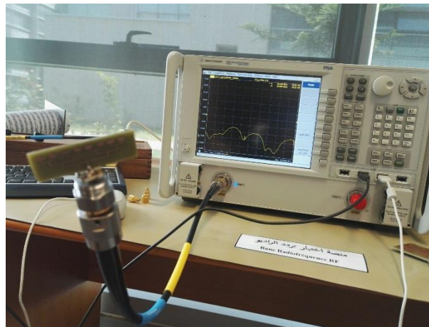
Figure III-25: Mesure du réseau d'Antennes patch proposé à l'aide de l'analyseur réseau.
