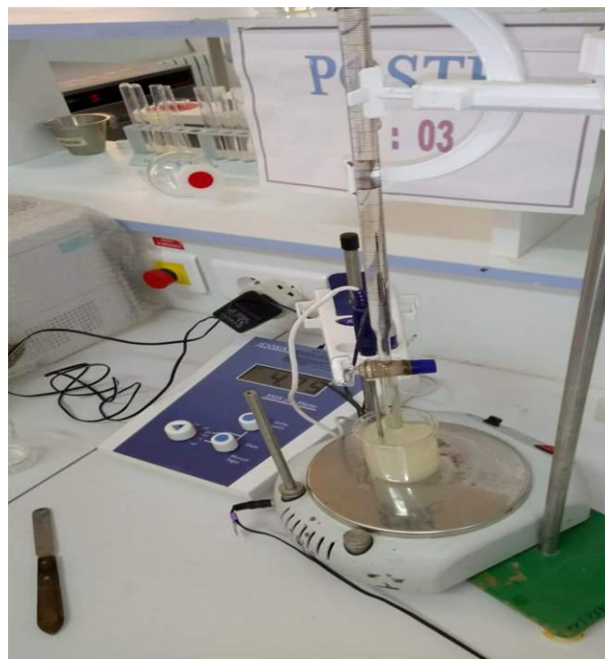
Fig. 4 :mode opératoire de la mesure de l'acidité.
