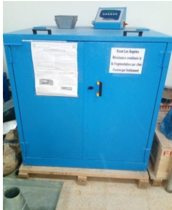
Photo 21 : machine de l'essai los anges
