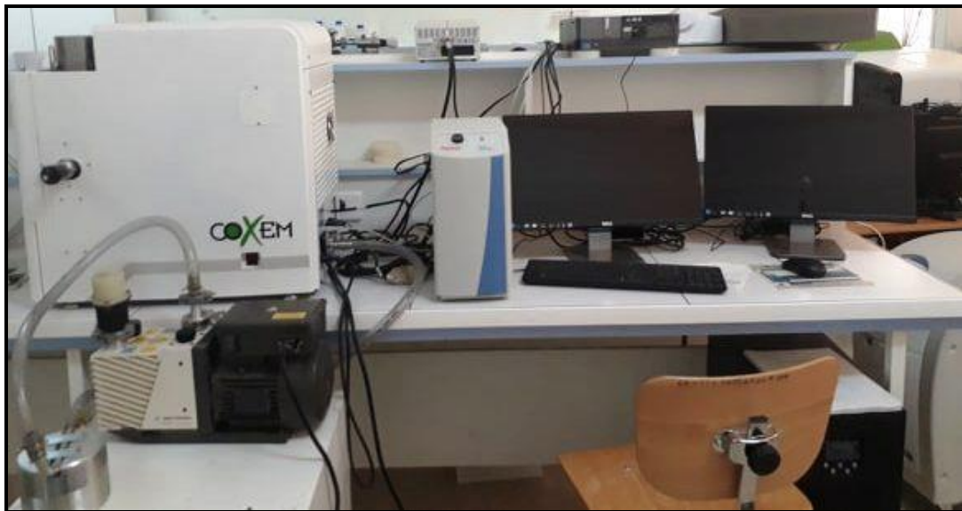
Figure 28: microanalyseur EDX couplé au microscope a balayage électronique MEB.
