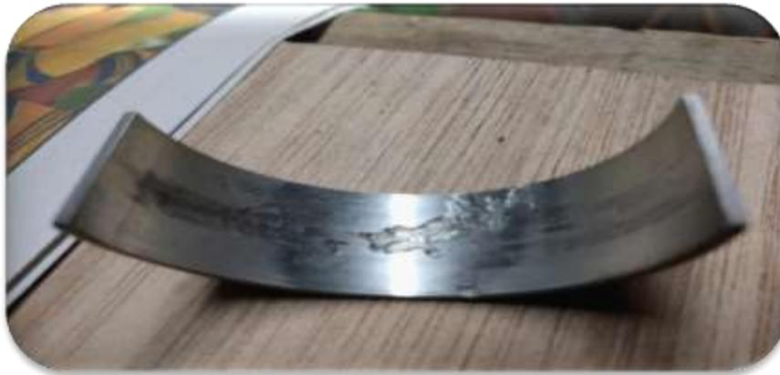
**Figure 1.16 : Coussinet de bielle érodé par la cavitation**
