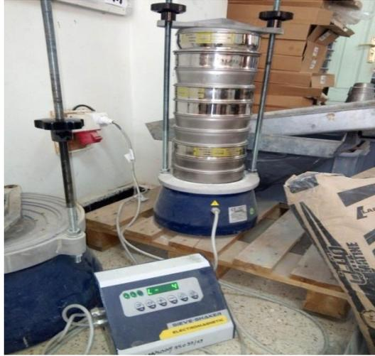
**Figure II-4 : Essai de l'analyse granulométrique.**
