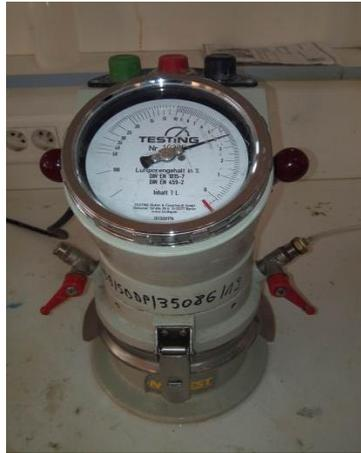
*Figure II-20: Essai de l'air occlus.*
