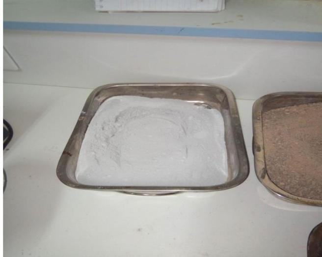
*Figure II-9: La fumée de silice utilisée.*
