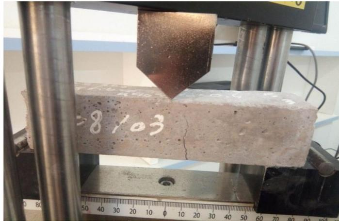
**Figure II-23: Essai de flexion simple effectué sur une éprouvette du mortier.**
