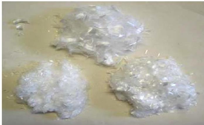
*Figure I-3 : Fibres polypropylènes de 6, 12 et de 19 mm [40].*
