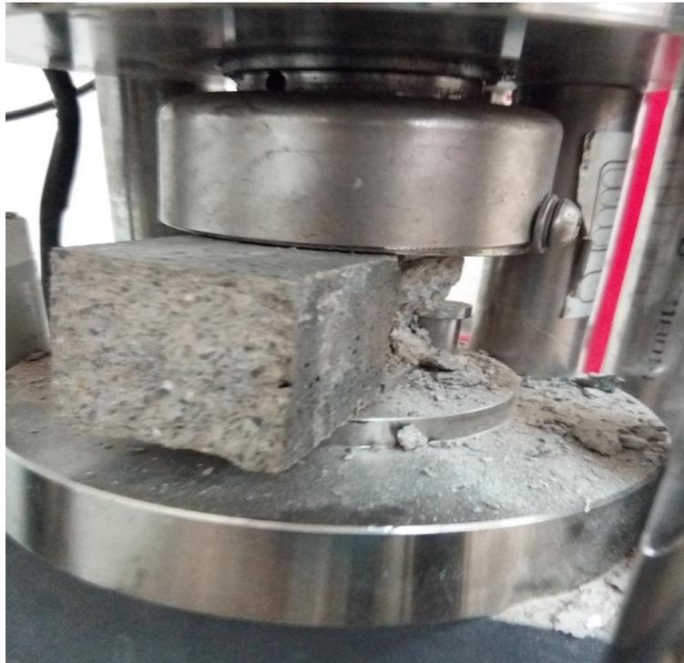
**Figure II-24 : Essai de compression simple d'un échantillon du mortier.**
