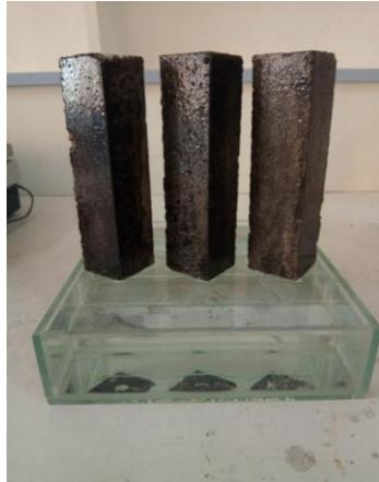
**Figure II-25 : Dispositif de mesure de l'absorption capillaire.**
