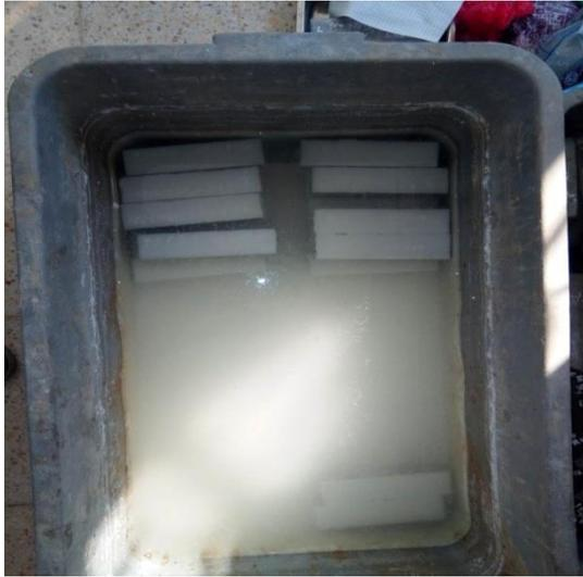
**Figure II-14: Conservation des éprouvettes dans l'eau.**
