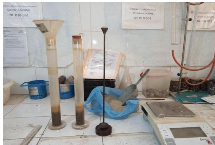
Figure II-6: Essai de l'équivalent de sable.
