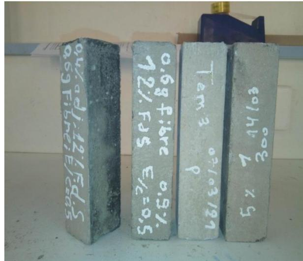
**Figure II-15: Séchage des éprouvettes à l'air libre pendant 24 h avant l'essai.**
