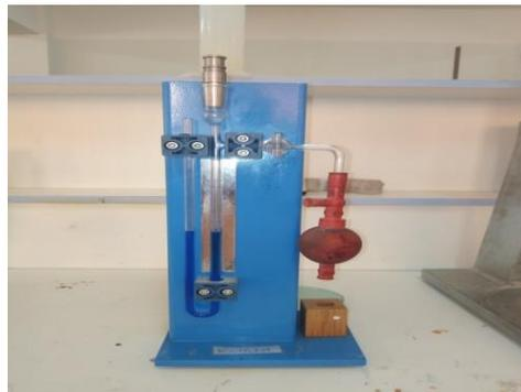
**Figure II-2 : Perméabilimètre de Blaine.**
