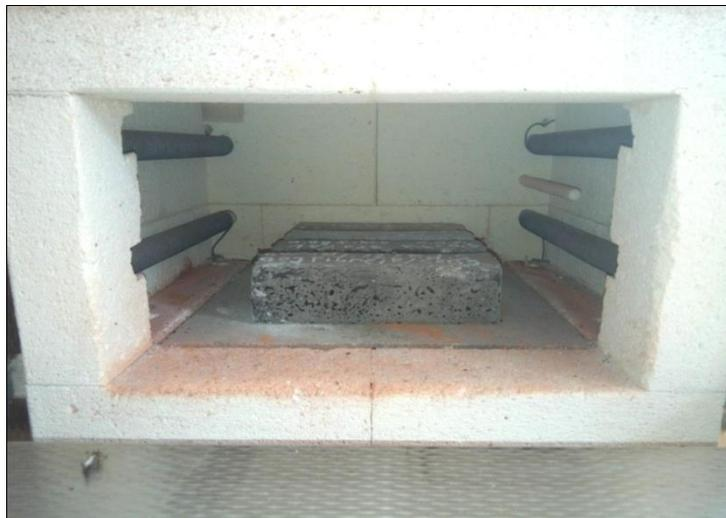
**Figure II-16: Le four à moufle utilisé pour le chauffage des éprouvettes [laboratoire de G. Civil - Univ Aïn-Témouchent].**
