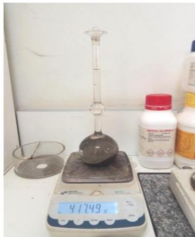
**Figure II-3: Pycnomètre utilisé pour la mesure de la masse volumique absolue.**
