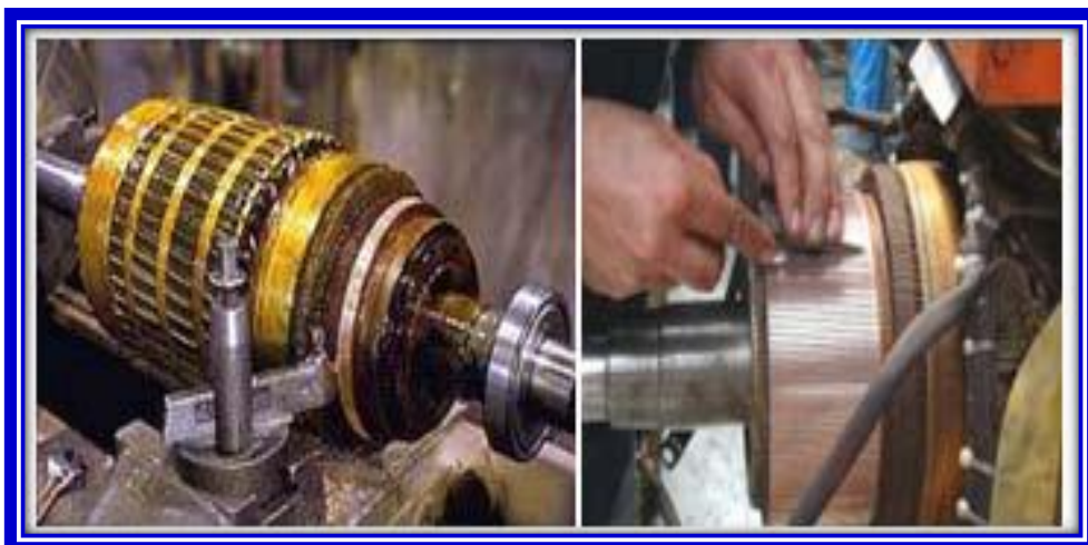
Figure. I.3 : Composition de l'induit [3]
