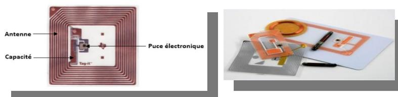
Figure II-4 : étiquette RFID [29]
