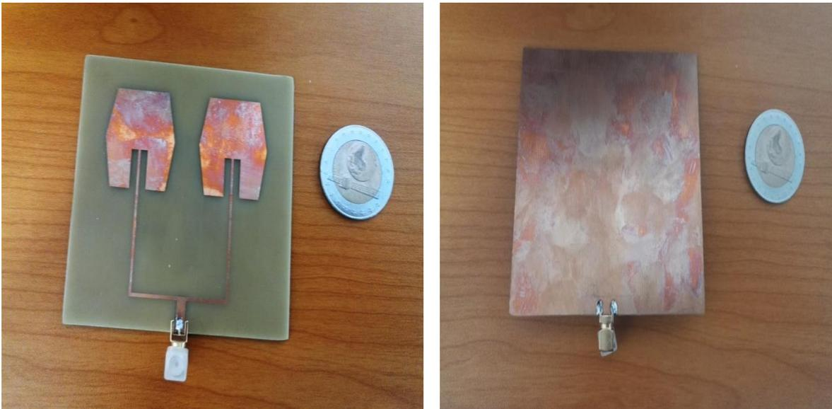
Figure III.34: réseaux d'antenne (2×1) à réaliser (face supérieure et inférieure)
