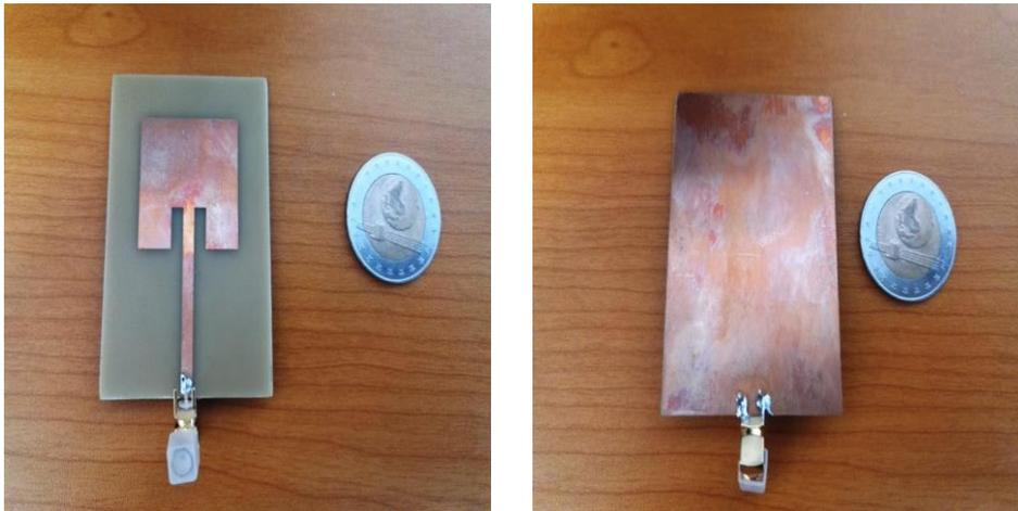
Figure III.22 : Antenne patch avec encoche à réaliser (face supérieur et inférieur)
