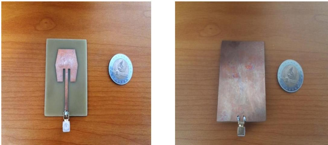
Figure III.28: antenne patch nouvelle structure à réaliser (face supérieure et inférieure)
