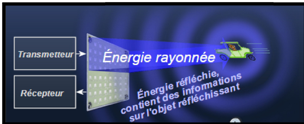
Figure II.3 : Radar à ondes entretenues utilise deux antennes souvent.
