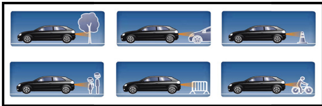
Figure III.17 : Les modes de détections de radar de recul.
