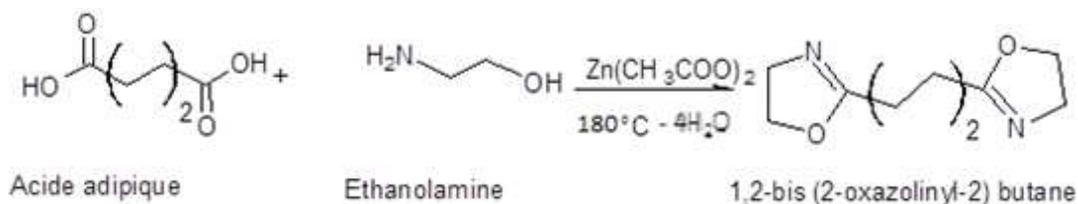
**Figure 18** : Bilan général de la réaction de formation de BBO
